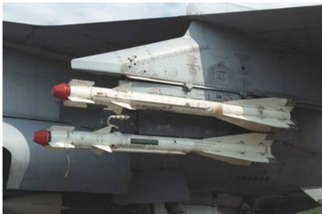
Photo 16. An R-60M Missile externally loaded on the aircraft Фото 16. Ракеты Р-60М на внешней подвеске самолета
