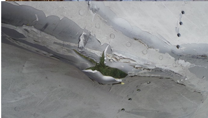
Photo 22. nature of the damage skin Boeing 777 Фото 22. Характер повреждений обшивки Boeing 777
